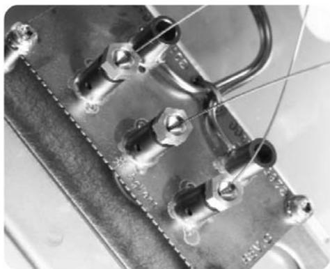
**Рис. 6. Микропоточковый делитель потоков с возможностью реализации обратной продувки**
