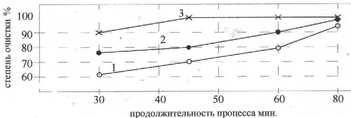
Рис.1. Зависимость степени очистки сточной воды от цианид иона от продолжительности процесса электролиза, при соотношении в растворе компонентов  $CN : Cl = 1-1:3, 2-1:5, 3-1:7$ , и расстоянии между электродами – 5 см
