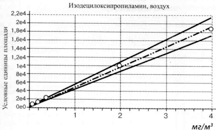
Рис. Градуировочный график зависимости площади хроматографического сигнала от концентрации ИДПА в воздухе
